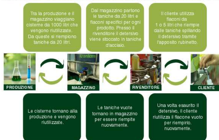
Figura 12: schema di funzionamento della distribuzione di prodotti mediante taniche a prelievo manuale. Fonte AQSystem, 2009
